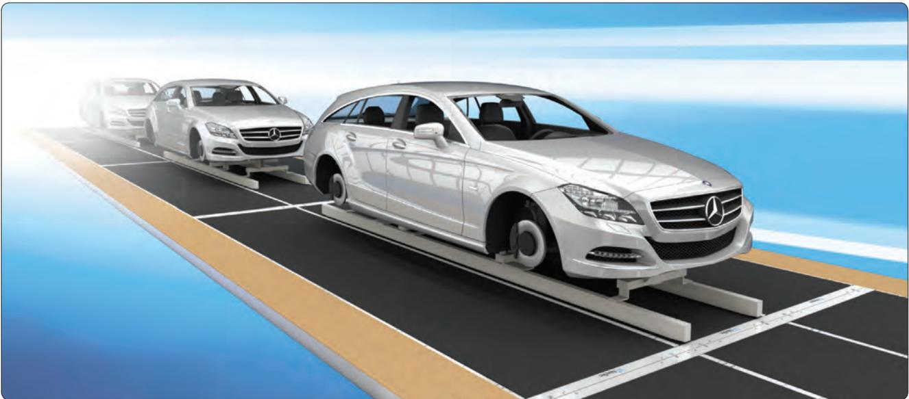
Kombination mit Skid-Bahnen
