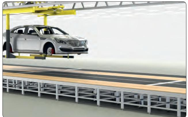
Band-Anordnung mit Podest und mit Unterbau für variable Höhe
