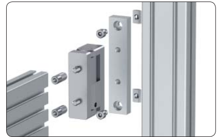
Befestigung des Profils 30×100 mit Gelenk 30×100
