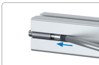
Schraube mit Schraubendreher durch die Hülse drücken
