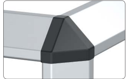
Eckstück-Satz 45° PA: Zur Verbindung von drei Profilen 40×40, 2E, 45°, LP
